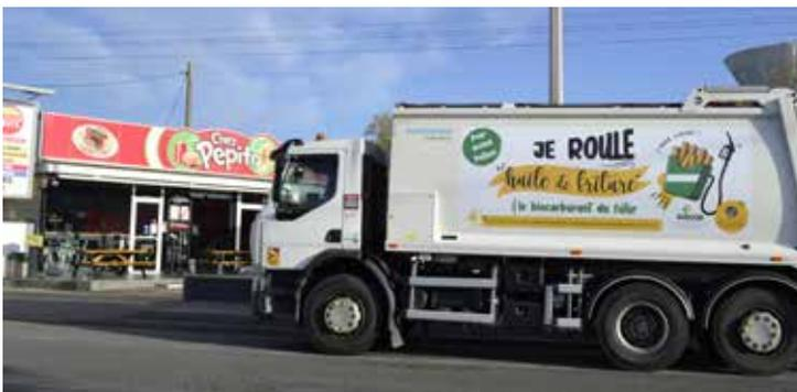
L'Agglomération a initié l'essai d'un carburant B100, sur 2 véhicules de collecte. Ce carburant issu d'huiles alimentaires transformées est produit dans la Région des Hauts-de-France et permet de réduire notre empreinte carbone.
