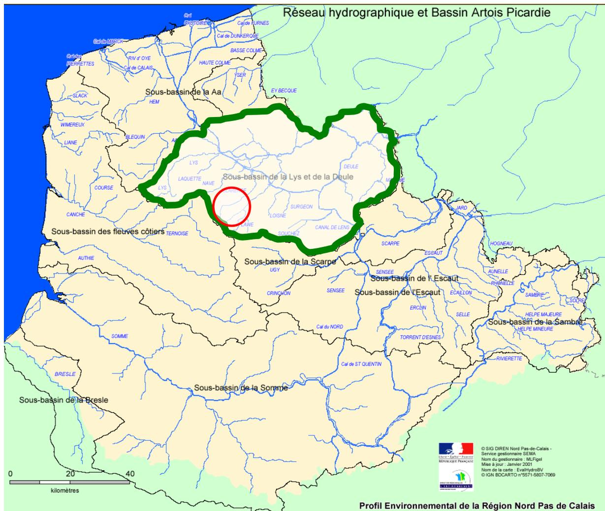
Le canal d'Aire à grand gabarit met artificiellement en communication les bassins versants de la Haute Lys et de la Deûle, le canal de la Sensée ceux de la Deûle et de la Scarpe. L'interconnexion est complète ; lors d'un étiage sévère, toute l'eau de la Haute Scarpe peut être détournée vers la Deûle. En temps de crue, les eaux de la Lys sont dirigées vers l'Aa, et noient la plaine.
