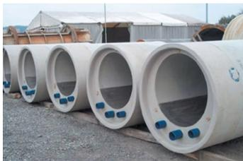
Ci -contre photos de canalisations équipées d'échangeurs thermiques.
