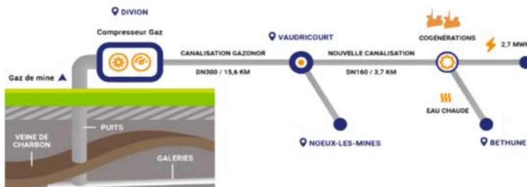
Figure 12 : captage du gaz de mine - source : La française de l'énergie
