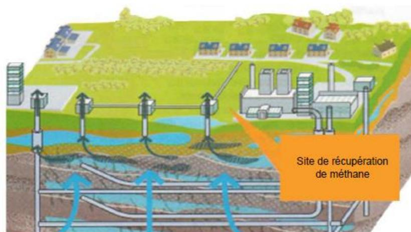
*Schéma de captage du gaz de Mine (Coal Mine Methane) ou grisou*
